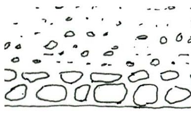
Soubassement en moellon jointoyé à la chaux hydraulique naturelle (NHL 2 ou 3,5)
