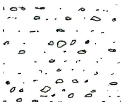
Mur en moellon enduit à pierre vue
