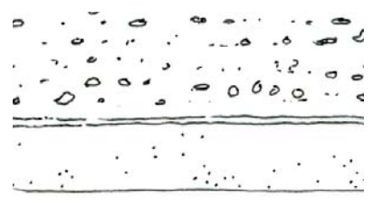
Soubassement enduit par un mortier épais à la chaux hydraulique naturelle (NHL 2 ou 3,5)
